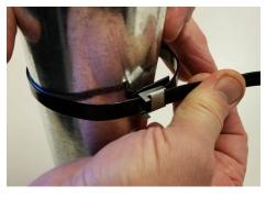
SQUEEZE HANDLE TO TIGHTEN STRAP AROUND PIPE
